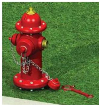
17) Retirez le capuchon de la buse du tuyau (#21) de la buse à remplacer. À l'aide de l'outil d'installation United Nozzle Lock Key (n° 13) et d'un marteau à griffes standard, retirez les clés de verrouillage de la buse. Placez la clé à buse sur la buse de manière à ce que les fentes de la clé et les pattes de la buse soient correctement alignées.
