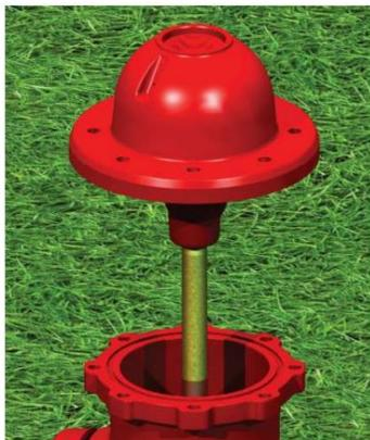
(13) Appliquez du lubrifiant FIREFLO sur le joint torique du chapeau et installez-le dans la rainure de la bride du tube vertical supérieur. Vérifier la lubrification appropriée et visser le manchon en laiton sur le tige supérieure et réinstallez le capot et les boulons du capot sans les serrer complètement.
