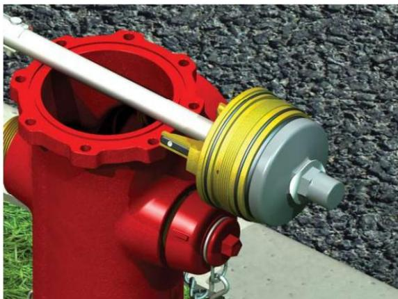
(11) Remontez les composants de la vanne selon l'ordre dans lequel ils ont été démontés. L'écrou de la plaque inférieure de la vanne (#49) doit être serré à env. 100 pi-lb. Pliez la rondelle de blocage (#48) sur un bord de la plaque inférieure de la vanne et sur un bord opposé de l'écrou de la plaque inférieure de la vanne.
