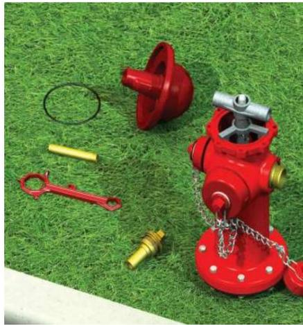
(6) Dévissez le manchon en laiton de la tige supérieure. Placez la bride de la clé de siège (dispositif de centrage à 3 branches) sur la tige et insérez la clé de siège (poignée en T) dans le trou jusqu'à ce que les fentes s'engagent dans la goupille de la tige (#33). Serrez la vis moletée et desserrez la tige en tournant la clé de siège dans le sens inverse des aiguilles d'une montre.
