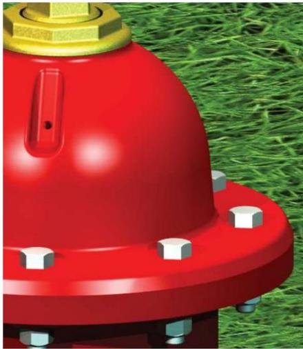
(16) Dévissez et retirez le bouchon d'huile. Avec la bouche d'incendie en position complètement fermée, remplissez l'orifice de remplissage d'huile jusqu'à ce que l'huile commence tout juste à déborder. Attention : n'insérez pas d'huile si la bouche d'incendie n'est pas en position complètement fermée ; sinon, la chambre peut devenir trop remplie, ce qui entraîne un blocage de la pression qui peut endommager les joints toriques et d'autres composants.
