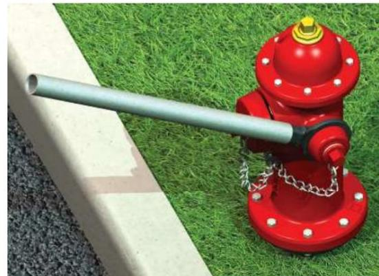
19) Glissez un morceau de tuyau en acier galvanisé ou en fer noir de 3 pieds (2" Schedule 40 min.) sur l'extrémité de la clé à buse pour obtenir suffisamment de levier pour desserrer la buse. Desserrer la buse dans le sens des aiguilles d'une montre (gauche- fils à main).
