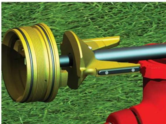
(9) Inspectez les revêtements de la vanne de vidange (#34) pour l'usure ou les dommages et remplacez-les si nécessaire.
