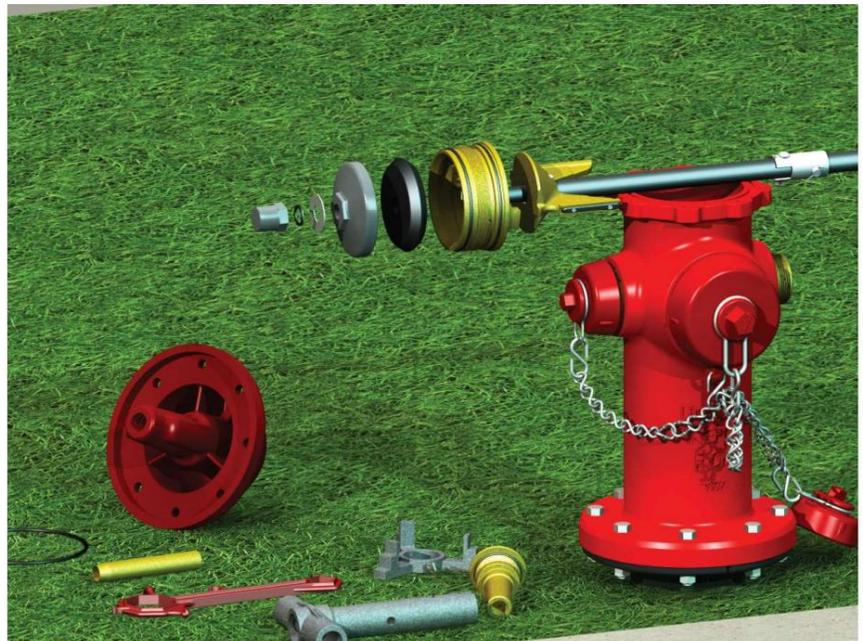
(8) Aplatissez la rondelle de blocage (n°48) et retirez les composants de la vanne : écrou de la plaque inférieure de la vanne (n°49), joint d'écrou borgne (n°47), plaque inférieure de la vanne (n°46), vanne principale (n°45) et bague de siège (#43). Nettoyez, inspectez et remplacez toute pièce usée ou endommagée.
