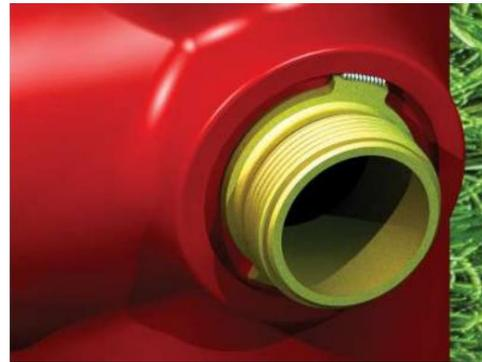
21) À l'aide de l'outil d'installation de clé de verrouillage de buse et d'un marteau à griffes standard, enfoncez les clés de verrouillage de buse entre les pattes et le diamètre intérieur des évidements de buse. Assurez-vous que les clés de verrouillage de la buse sont centrées dans le sens de la longueur avec les pattes de la buse. Effectuez la procédure de test de fuite standard.
