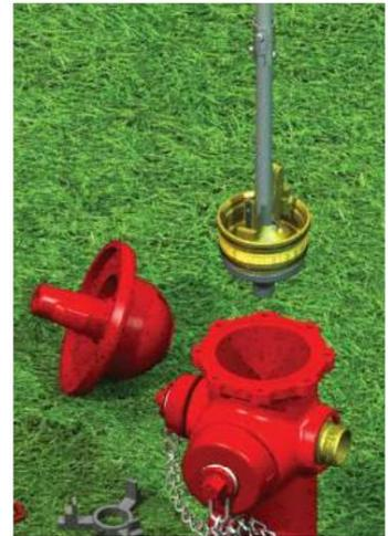
(7) Retirez la clé de siège et la bride de la clé de siège. Soulevez délicatement l'assemblage de la tige de la bouche d'incendie.
