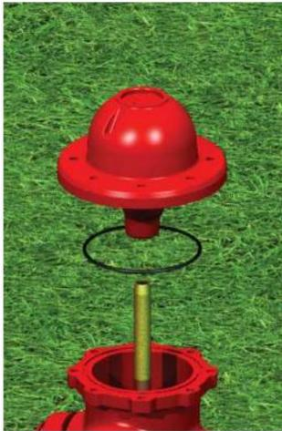
(5) Retirez le chapeau (n°8) en retirant d'abord les boulons et les écrous (n°9), puis en le soulevant doucement de la colonne montante supérieure (n°24). Retirez le joint torique du chapeau (n° 10) de la rainure supérieure de la bride du tube vertical.
