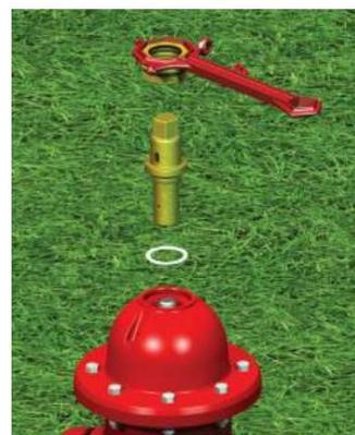
(15) Réinstallez l'écrou de fonctionnement et la rondelle antifriction. Avant d'installer l'écrou de maintien, inspectez le joint torique et remplacez-le s'il est fissuré ou fendu. Appliquez du lubrifiant FIREFLO sur le joint torique et installez l'écrou de maintien. Serrez l'écrou de maintien et les boulons et écrous du capot.
