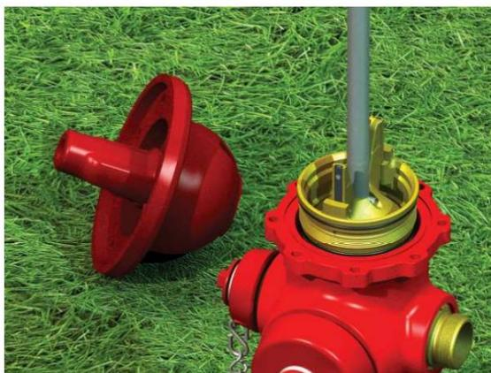
(12) Après avoir remonté les composants de la vanne, remplacez la tige en l'abaissant dans le corps de la bouche d'incendie. Veillez à ne pas endommager les joints toriques lors de l'abaissement de l'ensemble. Utilisez la clé de siège et la bride de la clé de siège pour serrer la tige à 375 lb-pi.
