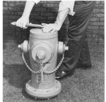
8. Retirez le bouchon de remplissage d'huile du boîtier. Versez l'huile de lubrification de bouche d'incendie MUELLER dans le réservoir d'huile jusqu'à ce qu'il soit au niveau de l'orifice du bouchon de remplissage d'huile. Remplacez le bouchon de remplissage d'huile et le bouchon étanche.
