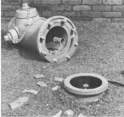
1. Mueller Hydrant avec Upper Barrel renversé par un véhicule.
