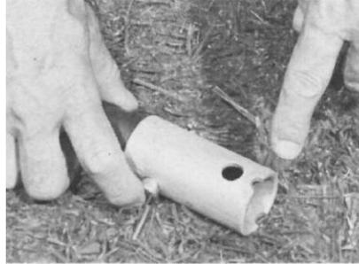
4. Assemblez le nouveau couplage de tige de sécurité à la tige supérieure avec une nouvelle goupille de chape et une goupille fendue en acier inoxydable. L'accouplement de tige de sécurité doit être installé avec des encoches vers la tige inférieure.
