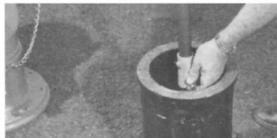
6. Assemblez la tige supérieure et l'accouplement de la tige de sécurité sur la tige d'extension et fixez-la avec une goupille de chape et une goupille fendue en acier inoxydable. ASSUREZ-VOUS QUE LE COUPLAGE DE LA TIGE DE SÉCURITÉ EST INSTALLÉ AVEC LES ENCOCHES VERS LA TIGE INFÉRIEURE. MOTS « C'EST FINI » VERS LA TIGE SUPÉRIEURE.
