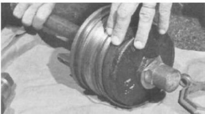
5. Avec l'écrou borgne serré à 100 lb-pi sur la bouche d'incendie de 5 1/4 po ou à 50 lb-pi sur la bouche d'incendie de 4 1/2 po, pliez les bords de la rondelle de blocage en acier inoxydable sur un plat sur la plaque de soupape inférieure et un plat sur l'écrou borgne.
