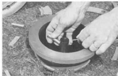
3. Retirez la goupille fendue en acier inoxydable de l'axe de chape en acier inoxydable dans la tige inférieure et jetez ces pièces.
