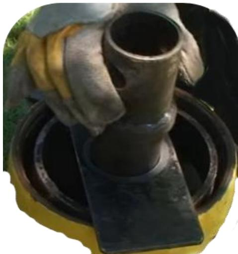
2. Insérer la barre d'acier ronde dans les orifices de la clé, puis dévisser le siège dans le sens anti-horaire (vers la gauche).
