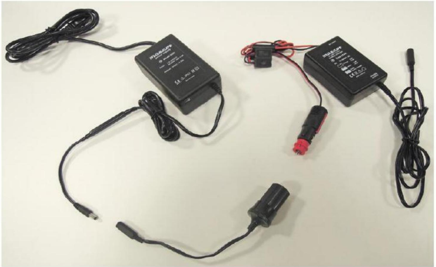
Figure 4.3 Connexion du cordon d'alimentation secteur au chargeur automobile à l'aide de l'adaptateur de câble.
