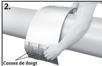
2. Formez les sections de collier de serrage à la courbure du tuyau sur lequel les sections seront installées. Utilisez un tuyau de plus petit diamètre pour obtenir un arc de courbure approprié pour chaque section. **Remarque : Toutes les bandes formées doivent être utilisées avec au moins une autre bande formée pour s'adapter correctement au tuyau.**
