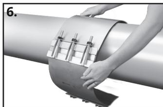
5. Accrochez la barre de levage derrière la barre latérale et serrez légèrement à la main les écrous. Assurez-vous de laisser un grand espace entre toutes les sections pour le réglage après l'installation sur le tuyau.
