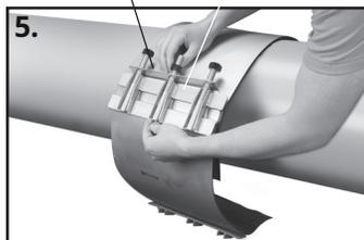
4. Placez les goujons d'une section dans/entre les ergots d'une autre section, en vous assurant que les ergots de la deuxième section sont à l'extérieur de la pince, contre la barre latérale.
