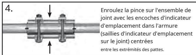
Enroulez la pince sur l'ensemble de joint avec les encoches d'indicateur d'emplacement dans l'armure (saillies d'indicateur d'emplacement sur le joint) centrées entre les extrémités des pattes.
