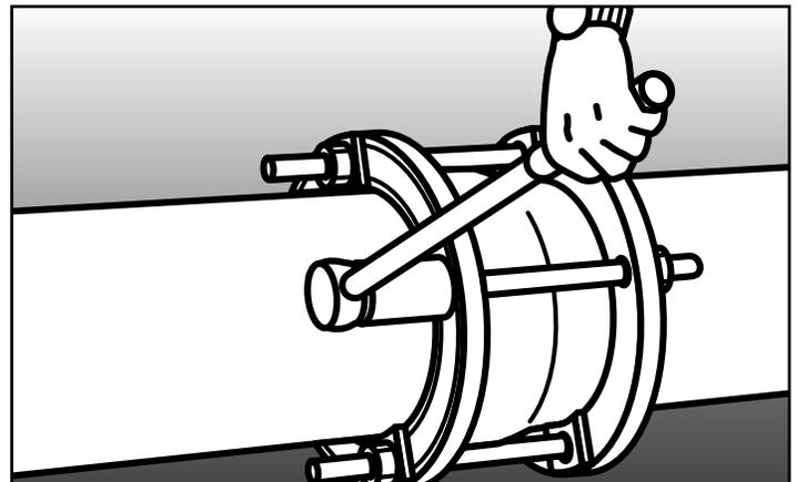
**Étape 5.** Serrez les écrous uniformément jusqu'à ce que la fuite s'arrête. L'utilisation d'une clé dynamométrique est très recommandée et nécessaire pour garantir un couple correct. Pour de meilleurs résultats, attendez 10 à 15 minutes et revérifiez le couple approprié.
