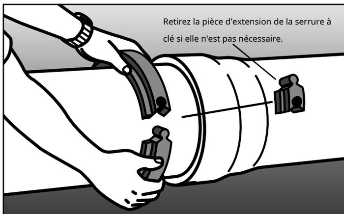
**Étape 3.** Lubrifier le joint pour de meilleurs résultats. Installez le joint autour du tuyau et verrouillez les extrémités ensemble. Le côté plat du joint doit faire face à la cloche. Placez la connexion de verrouillage à clé du joint à la distance maximale de tout joint de coulée. Jetez la pièce d'extension de verrouillage à clé du joint si le diamètre extérieur du tuyau est de 4,80", 6,90", 9,05", 11,10" ou 13,20".
