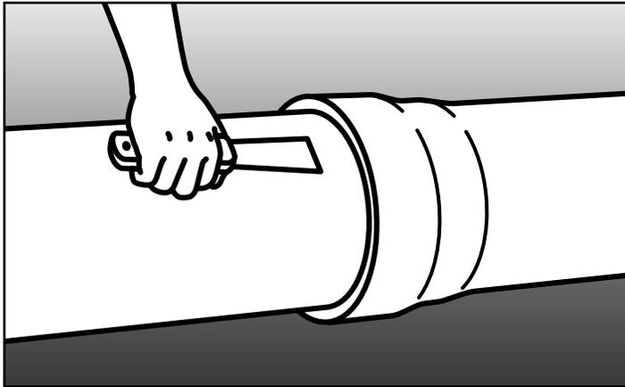
**Étape 2.** Nettoyez soigneusement la surface du tuyau autour l'emboîture et l'emboîtement. Si vous réparez un joint calfeutré, assurez-vous d'avoir une surface lisse et plane pour bonne étanchéité à l'eau.
