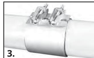
Serrez les deux sections de cosse ensemble. Serrez tous les boulons uniformément avec des réglages de couple incrémentiels, en maintenant des espaces égaux de chaque côté jusqu'au couple recommandé. Voir le tableau des couples ci-dessus.
