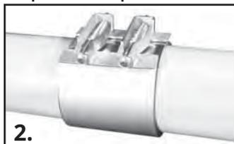
Accrochez un boulon intérieur dans la cosse du récepteur et serrez l'écrou à la main jusqu'à ce que le boulon soit bien fixé. Assurez-vous que les extrémités du joint sont à plat contre le tuyau et non pliées.
