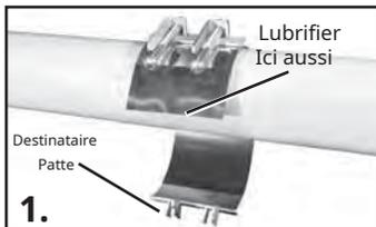
Desserrez les écrous jusqu'à l'extrémité des boulons, mais NE les retirez PAS. Séparez le collier et positionnez-le sur le tuyau avec la section de la patte de boulon sur le dessus.
