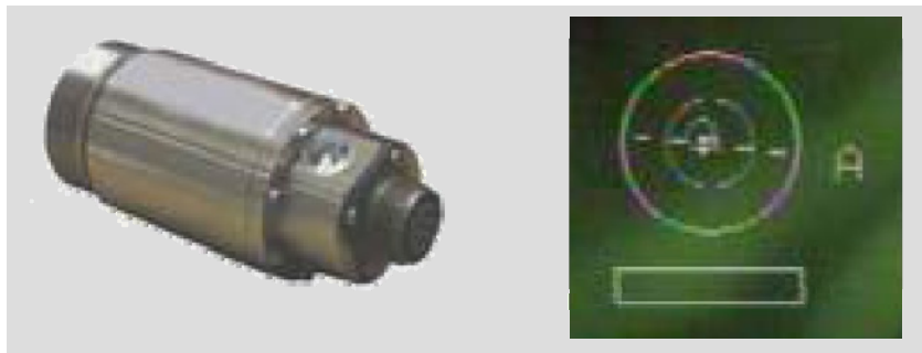
Figure 32 – Inclinomètre et image type lors d'un visionnement
