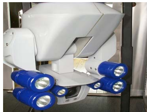
Figure 37 – Caméra à téléobjectif Gracieuseté de Aqua-Data
