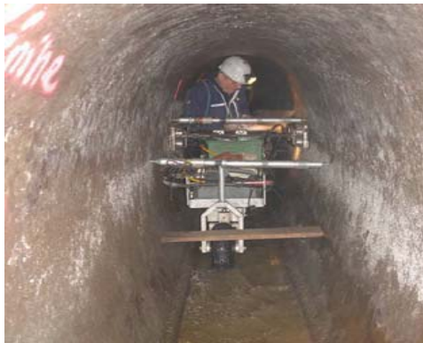
Figure 36 – Exemple d'une auscultation à l'aide de l'essai de vérinage interne
