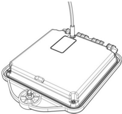
Figure 4.13 Chargement du bloc batterie li-ion du générateur
