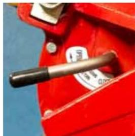
D. Poussez la barre d'alésage vers le bas jusqu'à ce que les filets d'arrêt du corps touchent le tuyau.
