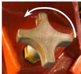
C. Appuyez sur la poignée de la vanne pivotante et tournez-la de 90 degrés dans le sens des aiguilles d'une montre.
