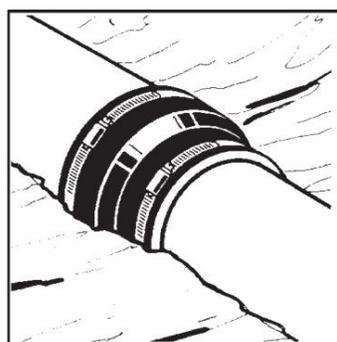
Test de pression\* avant remblayer ou dissimuler un joint. Assemblez et remblayer correctement.
