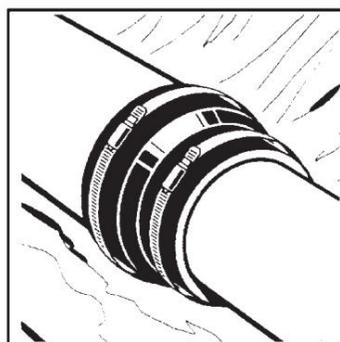
Faites glisser l'accouplement flexible sur l'extrémité du tuyau d'évacuation ondulé, en veillant à faire passer l'ondulation au-delà de la nervure à l'intérieur de l'accouplement.
