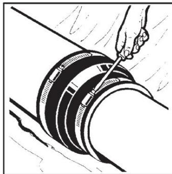
Insérez l'extrémité à bout uni du tuyau en PVC dans l'autre extrémité de l'accouplement flexible. Serrer la pince à 60 pouces-lbs. de couple.
