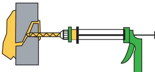
Pomper vigoureusement le pistolet pour expulser le coulis jusqu'au refus ou sceller. Si le coulis est lavé, pompez plus lentement ou arrêtez de pomper et surveillez le coulis jusqu'à ce qu'il réagisse à mi-chemin A (mélangeur), puis donnez rapidement une pompe pour expulser et répéter.
