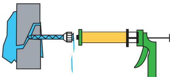
Préparez le pistolet en tirant sur les pistons E (pistolet à calfeutrer double) insérez D (tubes) tout en maintenant la position verticale, retirez C (embouts) de l'extrémité filetée des tubes
