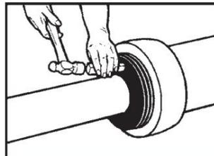
Insérez l'assemblage du beignet et du robinet dans l'ouverture.
