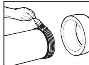
Lubrifiez l'extérieur de le Donut avec une solution savonneuse.
