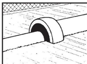
Testez le joint selon les spécifications de l'ingénieur. Testez la pression avant de remblayer ou de dissimuler.
