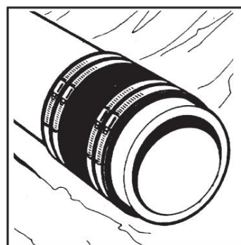
Coupez et retirez la section de tuyau. Desserrez les pinces. Faites glisser l'ensemble de couplage sur un tuyau en exposant l'extrémité du tuyau.
