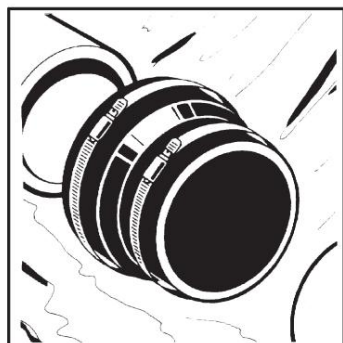
Desserrez les colliers en acier inoxydable. Ne retirez pas les colliers de l'accouplement.
