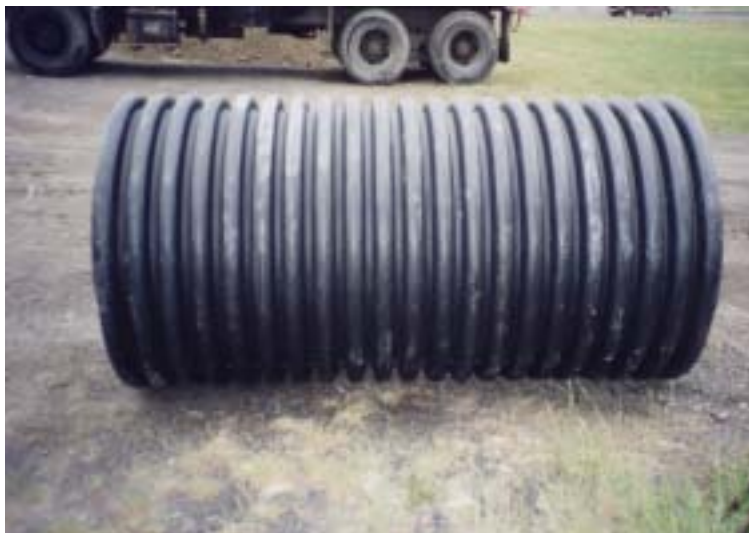
Figure 2.2 - Système de la Ville de Longueuil : tuyau PEHD-36 (diamètre nominal = 900 mm)
