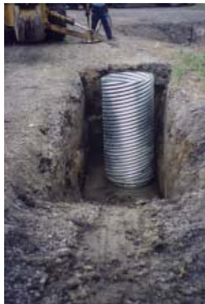
Figure 2.5 - Tuyau d'acier ondulé en tôle galvanisée TTAOG-36 HELCOR utilisé pour les essais en chantier (diamètre nominal = 900 mm ou 36 pouces )
