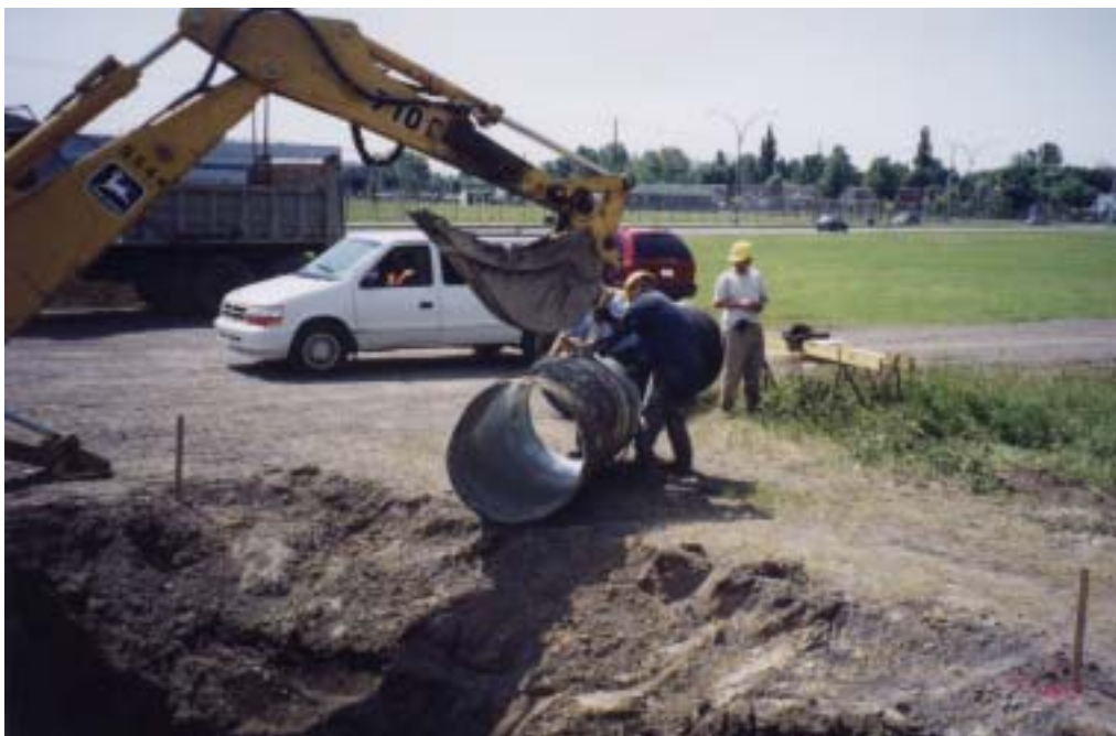
Figure 3.18 - Essai 1.1.B : Extraction et observation du TTAOG-36 après le chargement Ville de Longueuil
