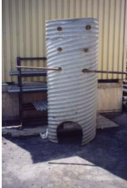
Figure 2.1 - Système de la Ville de Longueuil : tuyau TTAOG-36 (diamètre nominal = 900 mm)
