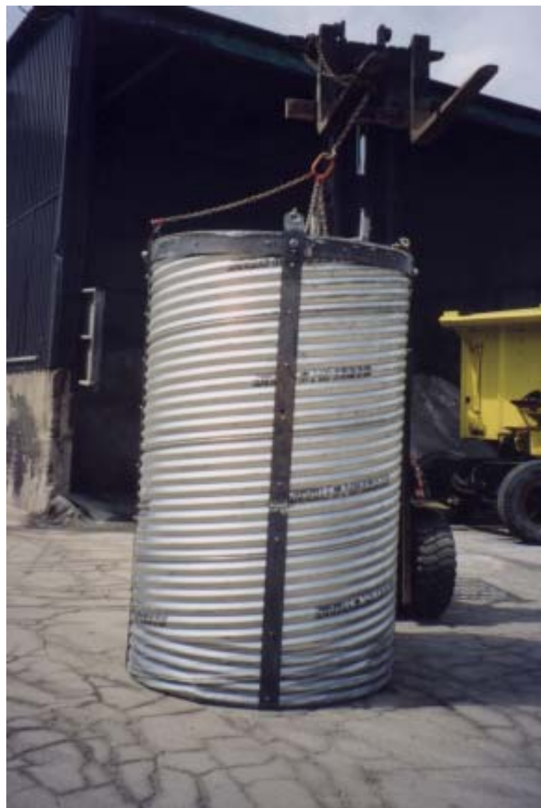
Figure 2.6 - Tuyau TTAOG-60 utilisé par la Ville de Victoriaville
