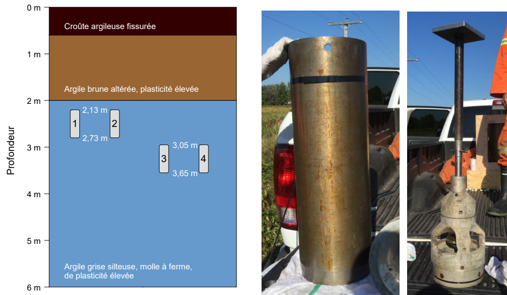
Figure 15. Prélèvement d'échantillons : position des échantillons dans la stratigraphie du site de Louiseville et photos de l'échantillonneur Laval.
