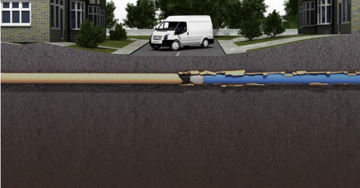
L'éclatement des tuyaux est un moyen sans tranchée conventionnelle de remplacer les tuyaux. L'idée derrière l'éclatement du tuyau est de fracturer le tuyau existant qui se détériore et d'enfoncer ses morceaux dans le sol autour de lui en utilisant une force mécanique interne, tout en tirant le tuyau de remplacement en place. Il n'est pas nécessaire de supprimer le tuyau existant.
